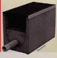
Caniveau épuratoire à substrat, filtration mécanique et chimique pour le traitement des eaux pluviales, Drainfix Clean de Hauraton cible les microparticules issues du trafic routier. Le système gère les eaux de ruissellement qui peuvent contenir des matières organiques, comme des feuilles ou des brins d'herbe.
