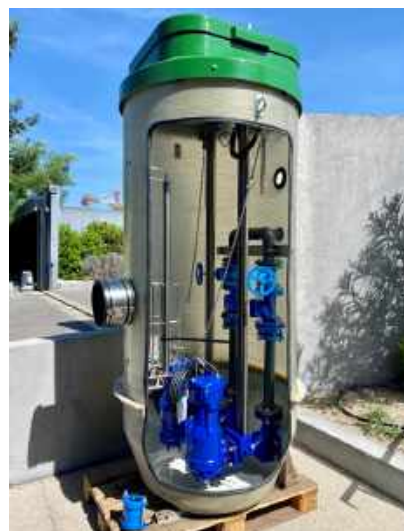
Poste SRA sur le site d'Aix-en-Provence de KSB. Cette station de relevage préfabriquée double pompe est destinée au relevage des eaux usées pour un débit jusqu'à 165 m 3 /h et une HMT maximum de 75 m.
